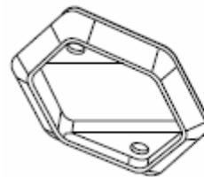
Joint d'étanchéité pour montage encastré (option 07)
